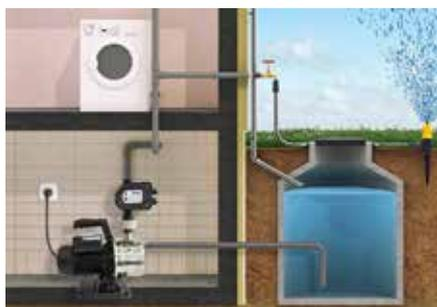
Le pompe AUTOJET sono dotate di pannello a LED per la verifica dello stato di funzionamento. È possibile controllare se la pompa è collegata alla rete elettrica, se la pompa è in funzione, se c'è flusso di acqua oppure se ci sono delle anomalie e di che tipo (es: marcia a secco)
