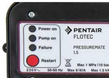
Superate le cause che hanno determinato il blocco è sufficiente premere il pulsante rosso Restart (riarmo) per ripristinare il normale funzionamento. In caso di temporanea interruzione dell'energia elettrica, l'apparecchio si riarma automaticamente al ritorno della stessa
