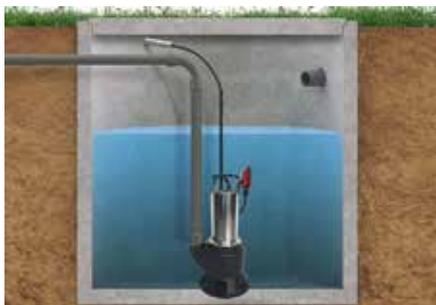
Pompa sommergibile per acque reflue. La MAXIVORT 50-36/14 è stata progettata appositamente per applicazioni particolarmente esigenti ed è ideale per il drenaggio di acque di infiltrazione, smaltimento delle acque domestiche, lo svuotamento e drenaggio di locali allagati e il prelievo di acqua da pozzi, bacini o cisterne
