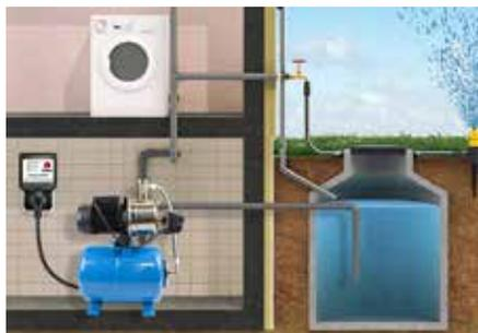
Queste pompe non sono adatte per acqua di mare o per acque contenenti sostanze corrosive o facilmente infiammabili.
