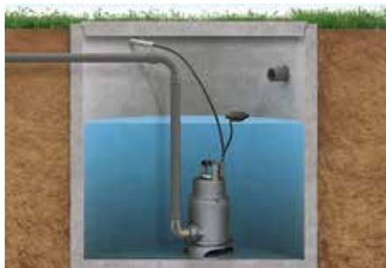
Le pompe FP e VIPVORT sono adatte al pompaggio di acque reflue con impurità fino a 25 mm (a seconda del modello). Sono dotate di albero motore in acciaio inox.
