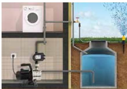
PRESSUREMATE 1.5 è un dispositivo elettronico che avvia e arresta la pompa in funzione dell'apertura e chiusura degli utilizzi. In caso di mancanza di flusso in aspirazione, l'elettronica manda in blocco la pompa proteggendola dal funzionamento a secco.
