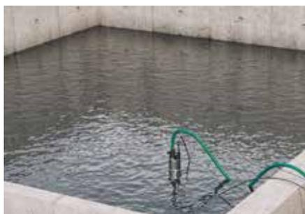
Le pompe Clearox sono pompe sommergibili per acque chiare dotate di galleggianti per un funzionamento automatico e di manico ergonomico per una presa sicura e una facile trasportabilità.
