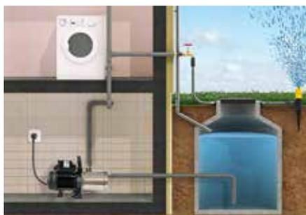
La serie Evo-Multimax è composta da pompe autoadescanti con sistema idraulico multicellulare.
