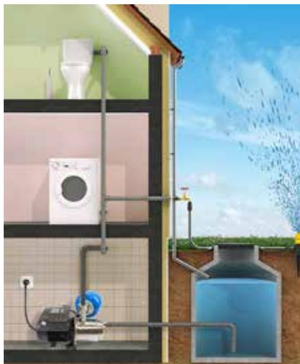
Evotronic 350 è un stema composto da un'elettropompa multicellulare autoadescante con corpo pompa in acciaio inox e da un convertitore di frequenza elettronico che, in base all'effettiva domanda di acqua, permette di mantenere la pressione costante nell'impianto, riducendo o aumentando la velocità di rotazione del motore dell'elettropompa.
