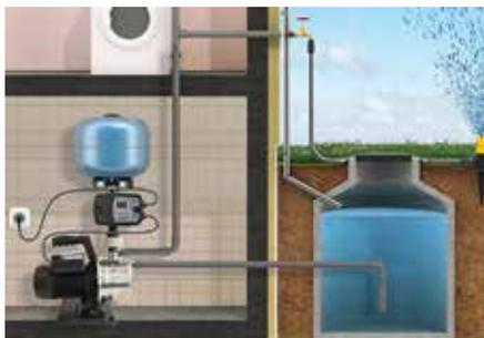
Digipress è un pressostato elettronico con manometro digitale integrato. Permette di gestire l'avvio e l'arresto di una pompa monofase fino a 2.2kW. Le pressioni sono facilmente regolabili attraverso il pannello di controllo dell'utente. Può operare come un interruttore di pressione differenziale, di pressione inversa o semplicemente con pressione massima e minima.
