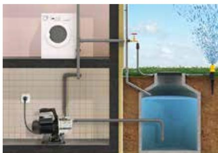
Queste pompe non sono adatte all'uso in acqua marina, acque sporche o acque contenenti liquidi corrosivi o altamente infiammabili. Il sistema idraulico di queste pompe è interamente in noryl.
