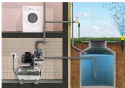
Queste pompe non sono adatte per acqua di mare o per acque contenenti sostanze corrosive o facilmente infiammabili. I livelli di pressione di avviamento e di arresto sono preimpostati dal costruttore (regolabili per esigenze specifiche e diverse) ma le pompe sono comunque dotate di un pressostato per la regolazione e la misurazione della pressione (standard o elettronico).
